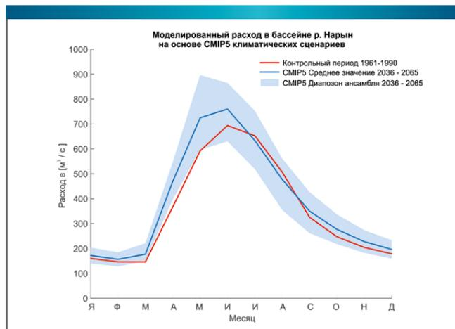
Проецируемые изменения среднемесячного стока на гидропосте Учтерек, на выходе из бассейна реки Нарын, и соответствующий диапазон сценариев (РТК 2.6 и 8.5). Изменения были смоделированы с помощью гидрологической модели WASA на основе результатов различных CMIP5 GCM.
