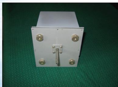
Единственным, включенным в реестр СИ РК, устройством измерения положения затворов ГТС является датчик угловых перемещений ДУП ПКТИ «Водавтоматика и метрология» г. Бишкек, Киргизия (рис. 8). Недостаток датчика это незавершенность конструкции - для измерения положения затворов необходимо изготовление дополнительного
