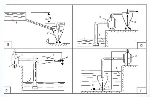
Рис. 1 - Различные схемы компоновки гидроциклона: 1- источник, 2- насос, 3- гидроциклон, 4-гидроэлеватор
