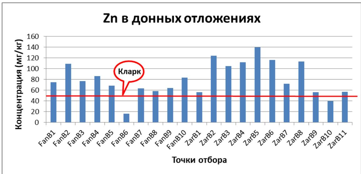
Рисунок 5. - Распределение Zn в донных отложениях
