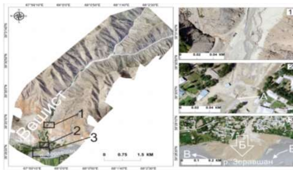
Рисунок 7 – Карта пострадавшего от стихийного бедствия территории села Вешист г. Пенджикент, Согдийская область. Разрешение снимков 17 см. Площадь 45 км 2 . А – разрушенный мост, Б- селевые отложения, В - русло реки Зеравшан
